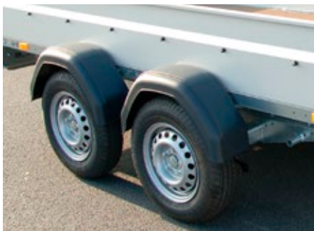
Alette in plastica a prova di urto
